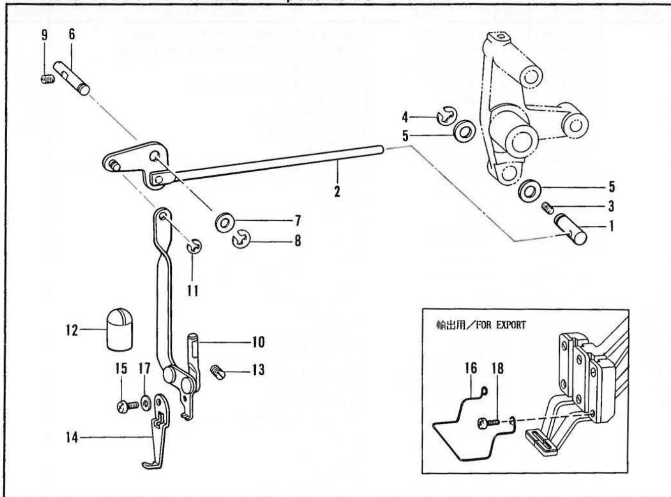
R. 糸締メ関係 / Thread nipper mechanism / Fadenspannvorrichtung /
