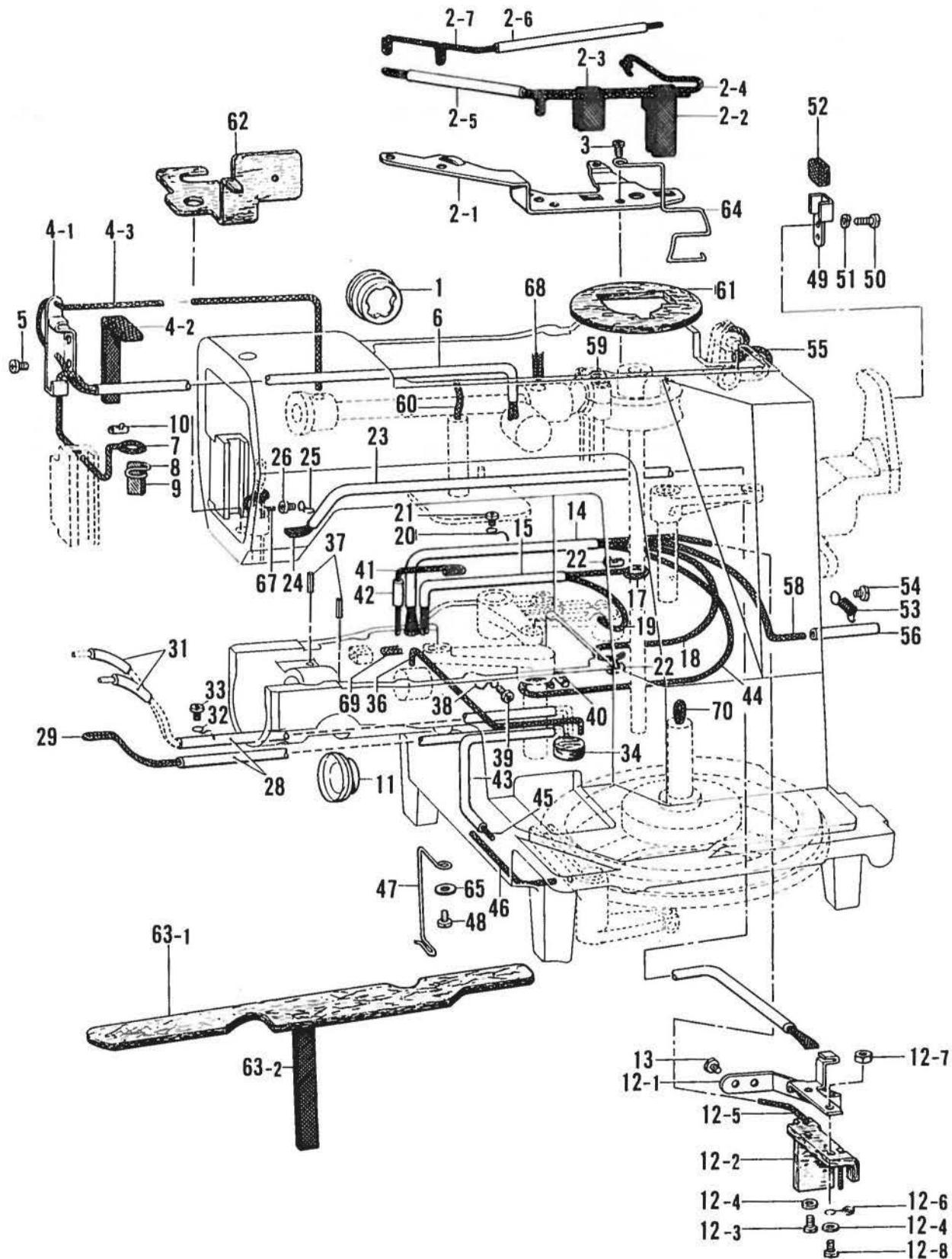
L. 給油潤滑関係/Lubrication/Schmierung/Lubrification/Lubricación
