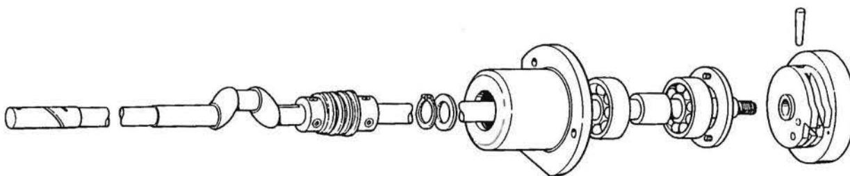
D. 動車・遊車関係 / Drive pulley and idler pulley mechanism / Antriebsriemenscheibe und Riemscheibe / Mécanisme de poulie d'entraînement et poulie folle / Mecanismo de polea impulsora y polea tensora
