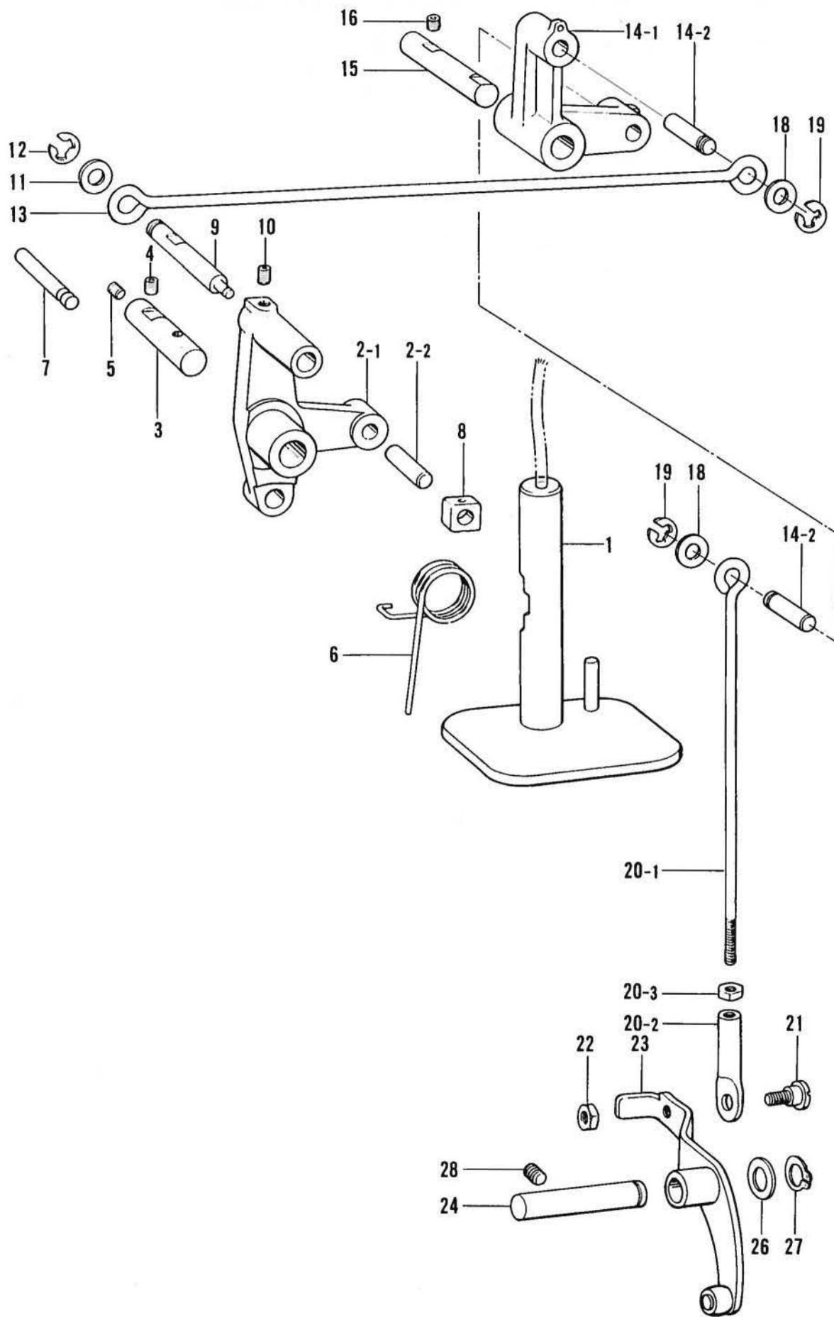
G. 押工上ヶ関係/Work clamp lifter mechanism/Stoffhalterhebervorrichtung/
